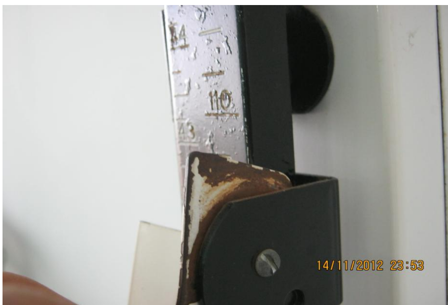
Componentes de báscula: medidor de nivel y regla vertical con muestra de oxidación debido a la falta de mantenimiento.
