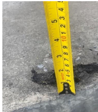
Imagen N°9 registro fotográfico del espesor de la carpeta asfáltica
