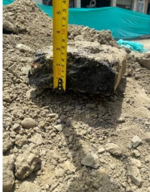
Imagen N°9 registro fotográfico del espesor de la carpeta asfáltica
