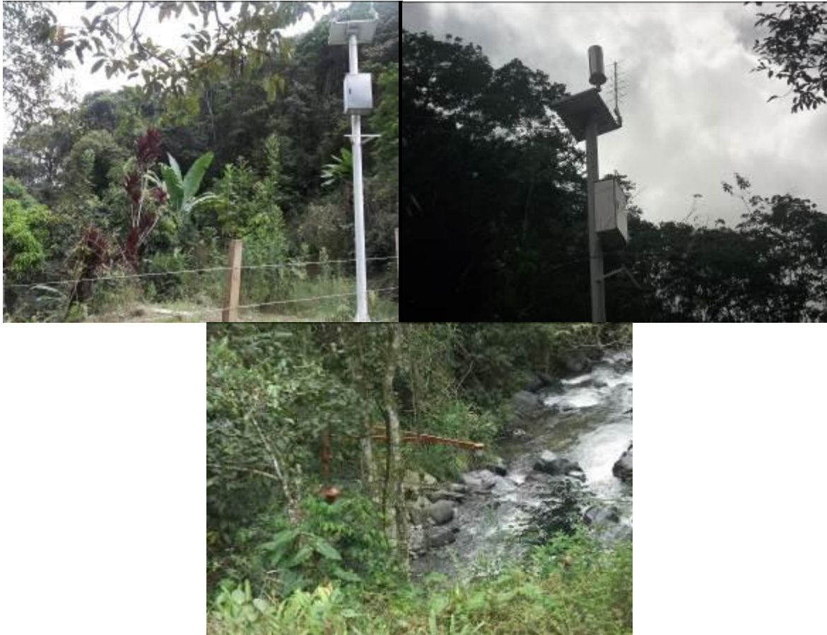
Equipo instalado por CVC para monitoreo de caudales del Rio Guabas –Observatorio
