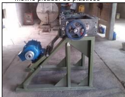
Molino triturador de Orgánicos y Lavadora de plásticos, equipos en proceso de fabricación y pintura
