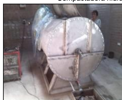
Molino triturador de Orgánicos y Lavadora de plásticos, equipos en proceso de fabricación y pintura
